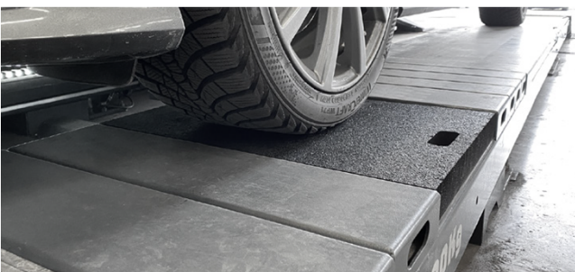
PLAQUES DE RIPAGE
